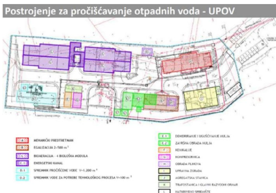
Slika 1. Tlocrt postrojenja UPOV Cuv
